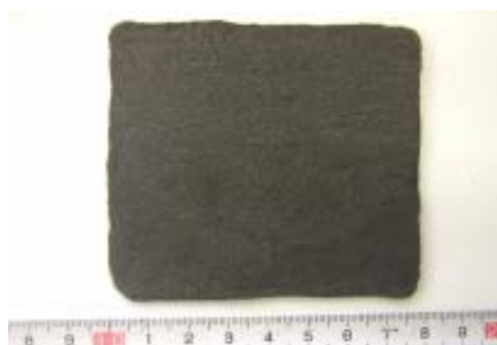
図1 スラリー法で作製したYBCO超電導体バルク材の外観写真
